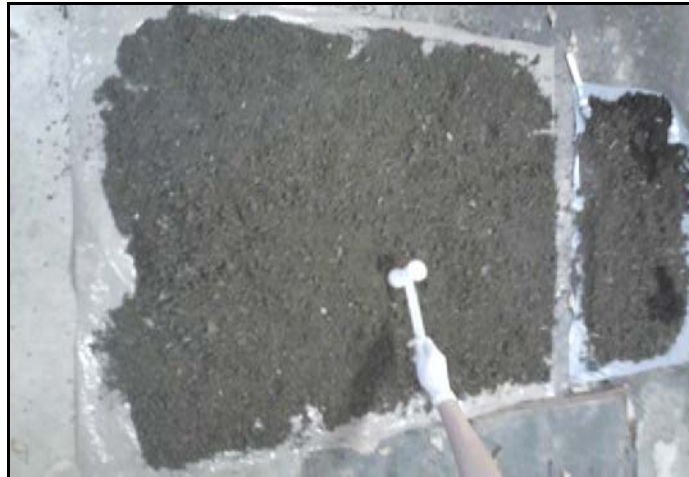
Figura 2 – Secagem e maceração do lodo até atingir 10% de umidade
